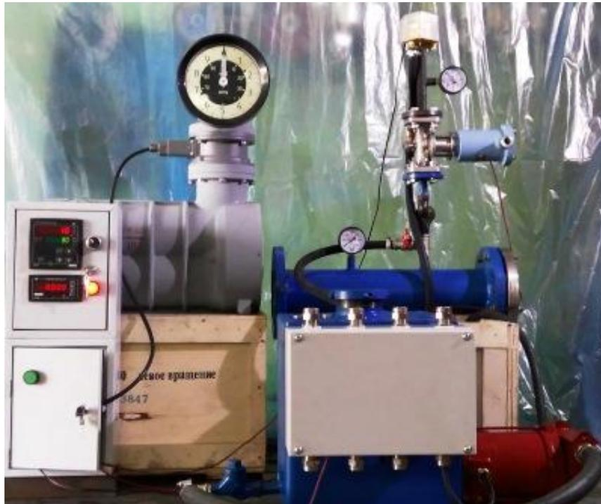
**Мобильный дозатор ввода присадки непосредственно в бак автоцистерны.** Может быть смонтирован на платформе для перевозки бочек с присадкой.
