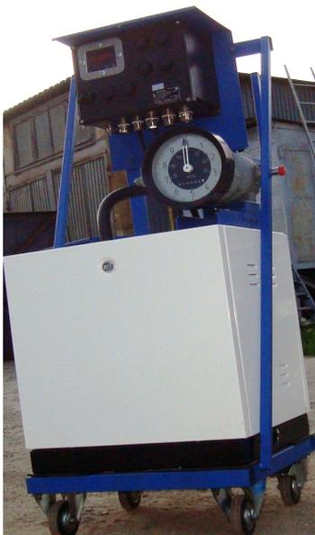
**Дозатор ввода повторяющейся дозы жидкости.**
